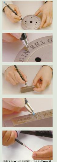
精密ストーンは先端部よりホルダーへ挿入してください。
